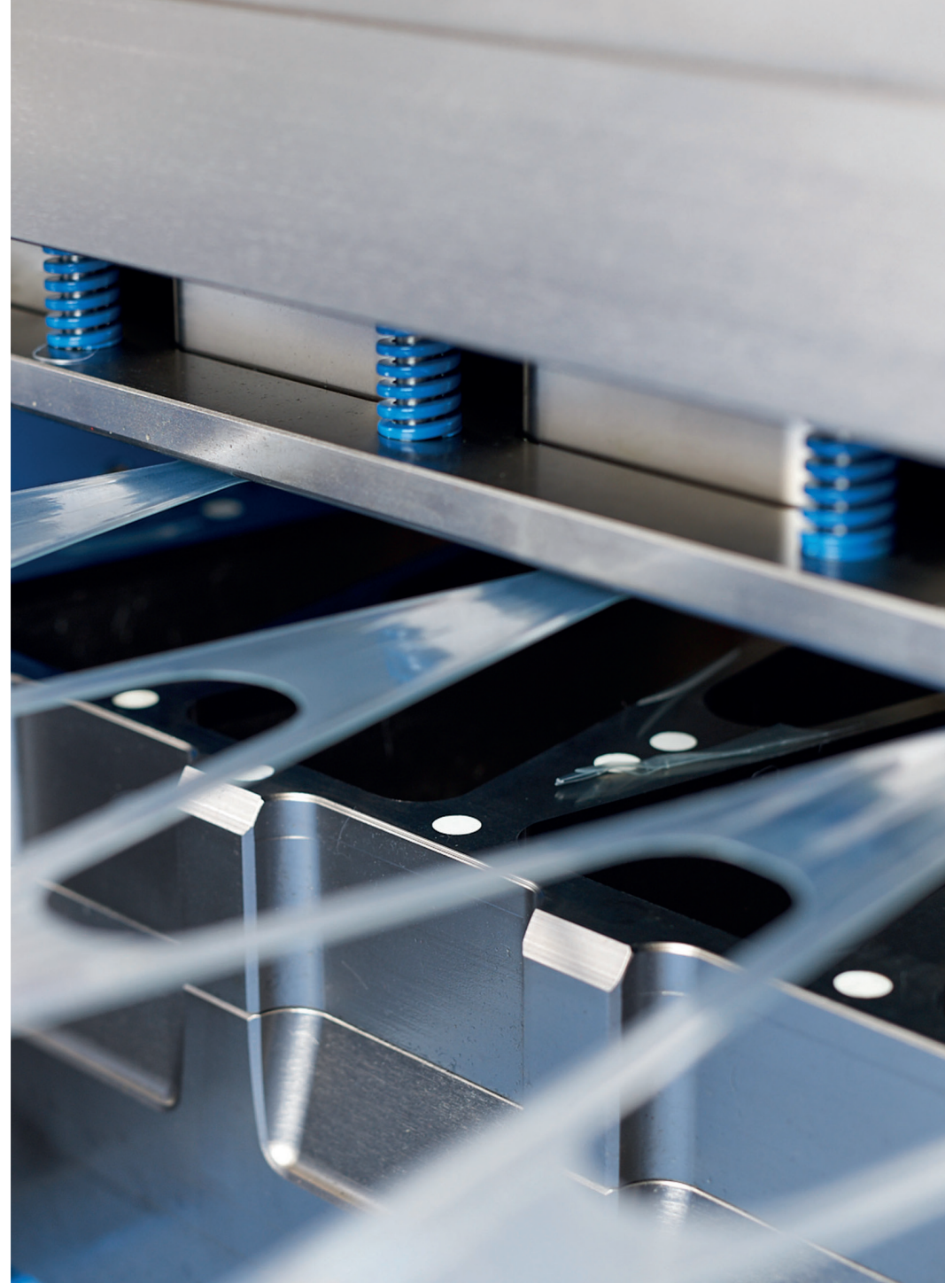
Komplettschnittstanze für individuelle Packungsformen
