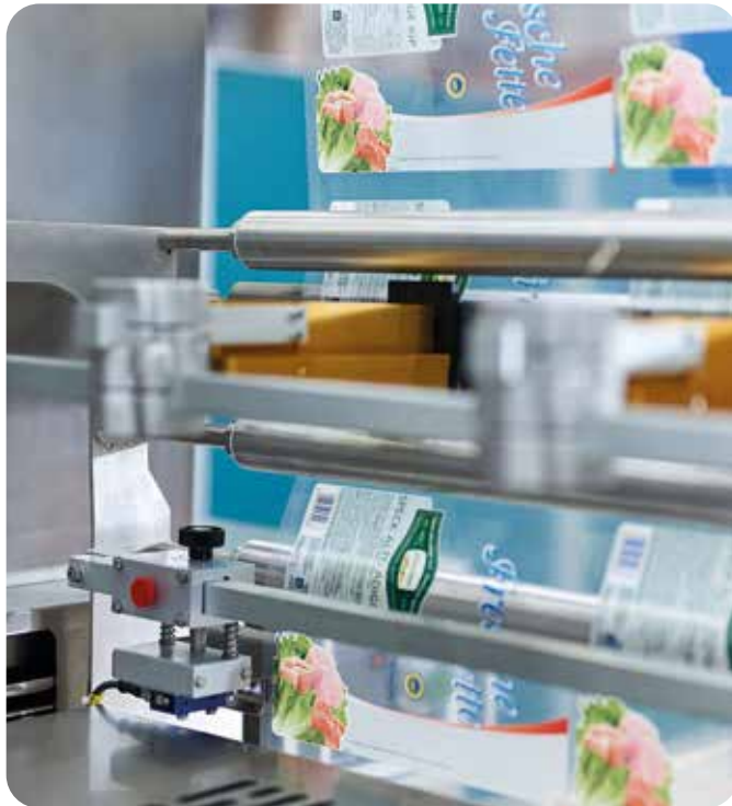
Druckmarkensteuerung an Oberfolienabrollung
